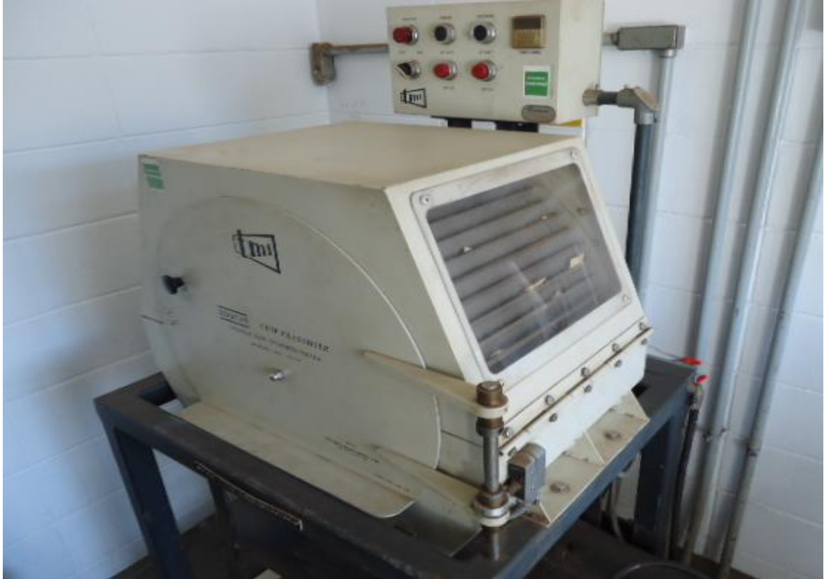
Fotografia 02 - Classificador de espessura de cavacos Fonte: Laboratório do Patio de madeiras da empresa (2011).
