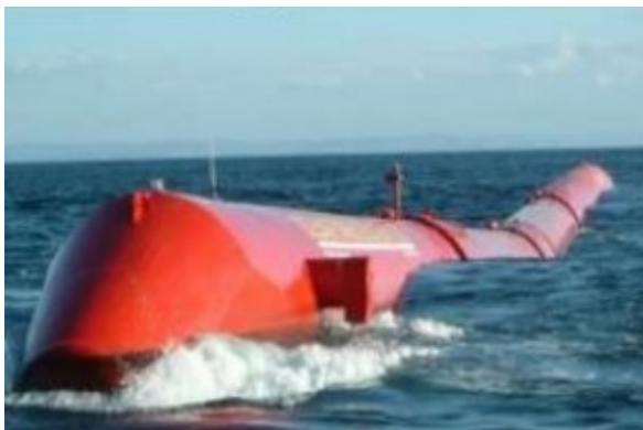
Figura 8 - Dispositivo de Conversão de Ondas Progressivo
