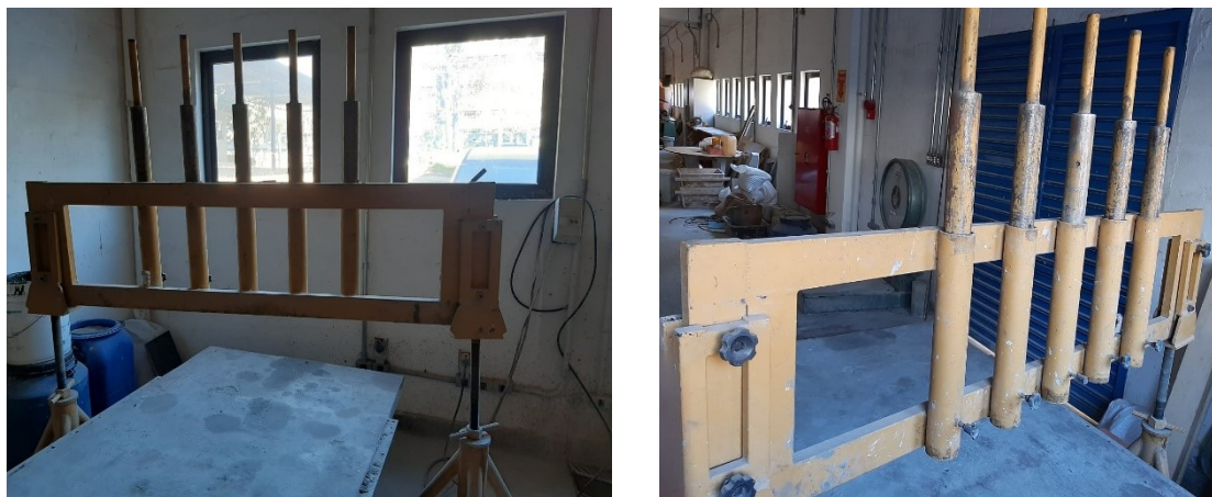
Figura 10 – Equipamento utilizado na moldagem dos corpos de prova cilíndricos
