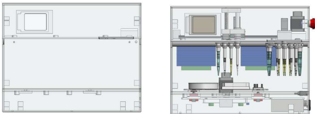
Figura 26: Vista frontal da bioimpressora.
