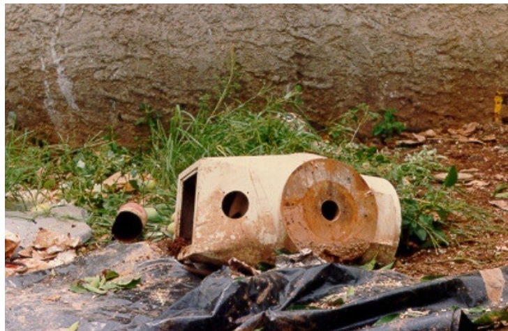
Figura 4: Cabeçote da bomba que continha do Cs-137 em Goiânia.
