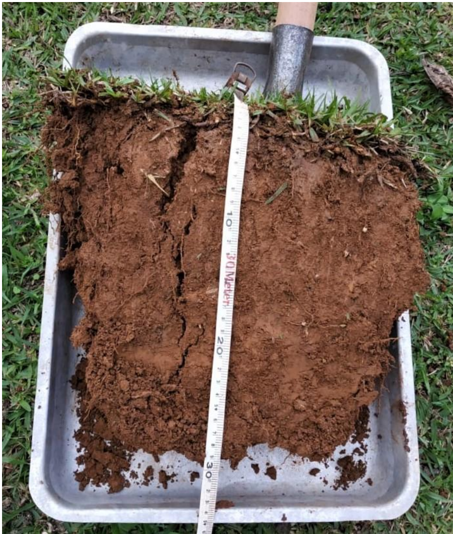
Figura 18: Dimensões do bloco de solo para análise de do índice de qualidade estrutural da amostra - IQEA.
