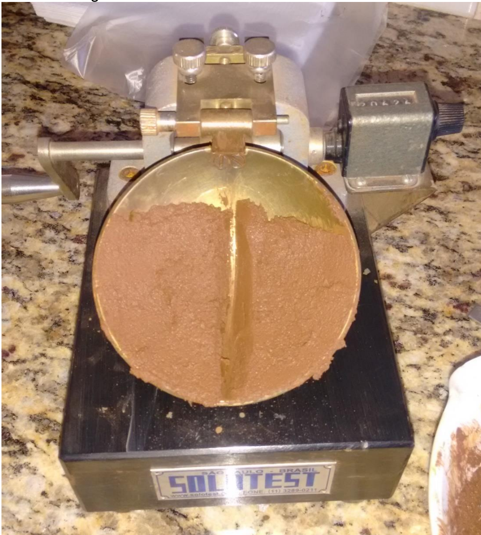
Figura 16: Procedimento de determinação de limite de liquidez utilizando aparelho de Casagrande.
