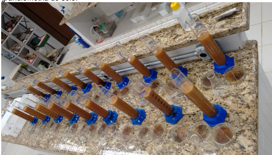
Figura 14: Cilindros de sedimentação e placas de Petri para determinação da granulometria do solo.
