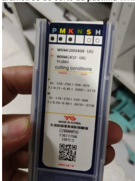
Figura 11 – Parâmetros de corte da pastilha WNMG080408-UG
