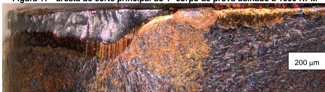
Figura 17 - aresta de corte principal do 1º corpo de prova usinado a 1000 RPM
