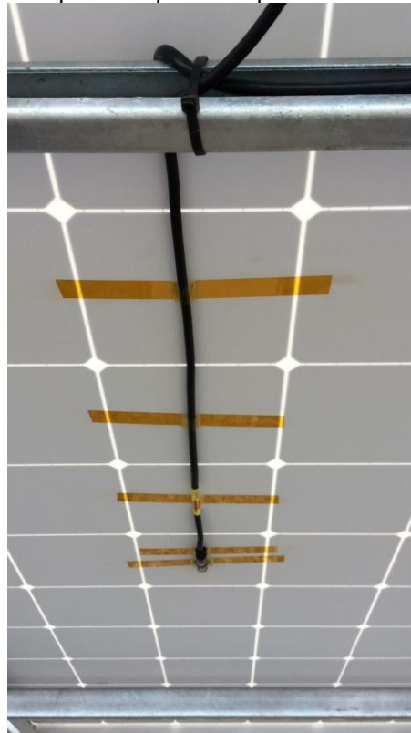
Figura 24 – Sensor de temperatura preso na parte traseira do módulo fotovoltaico.
