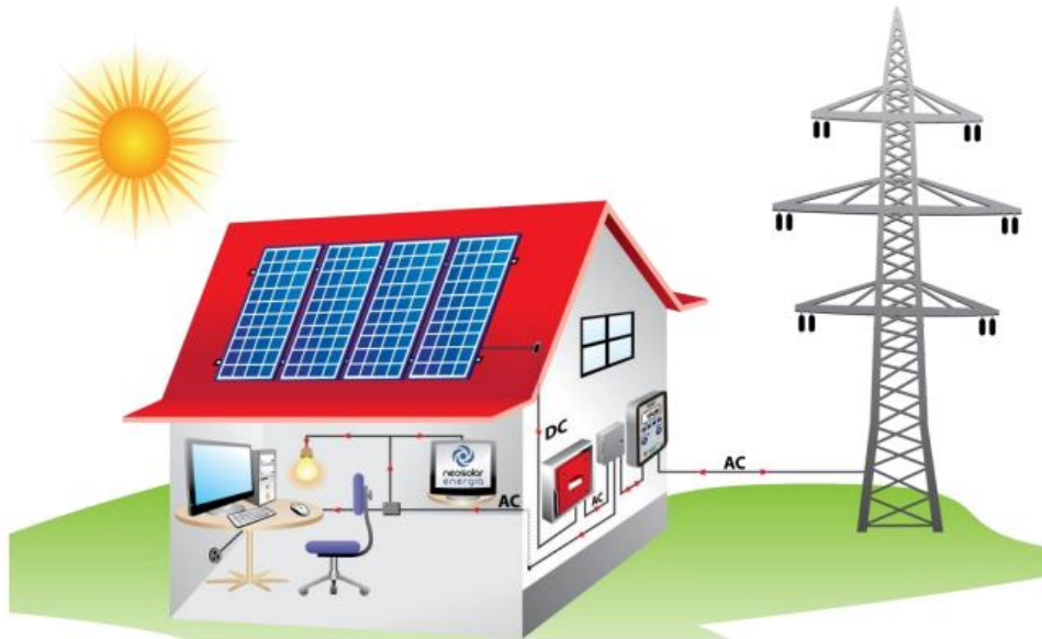
Figura 17 – Representação de funcionamento de um SFVCR.
