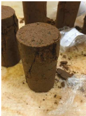
Figura 47: Corpo de prova após ensaio de RCS.
