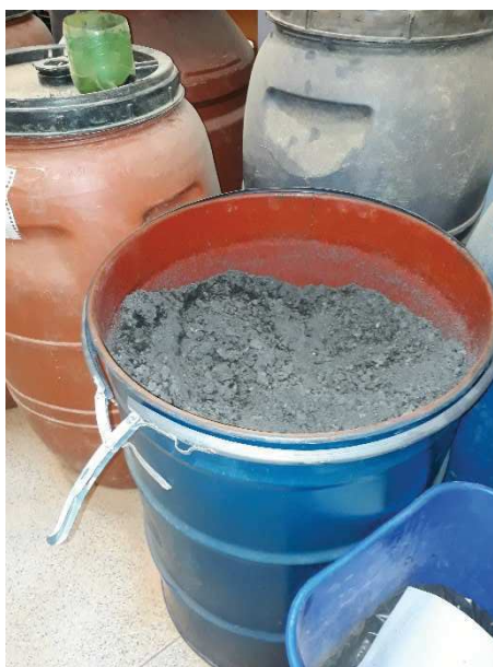
Figura 15. Armazenamento material fresado.
