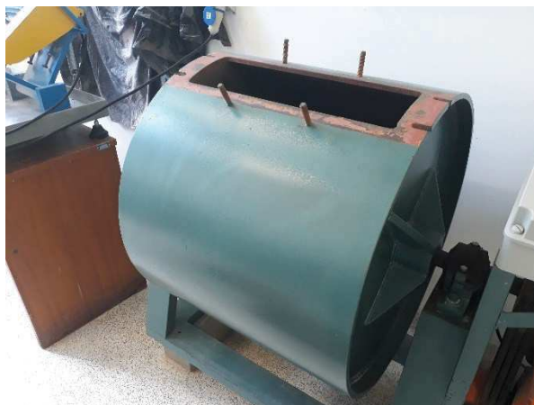
Figura 16. Destorroamento do material fresado.
