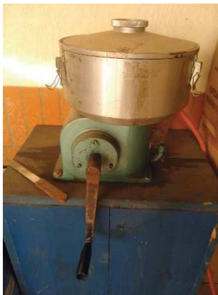
Figura 17. Equipamento utilizado no ensaio de teor de betume.
