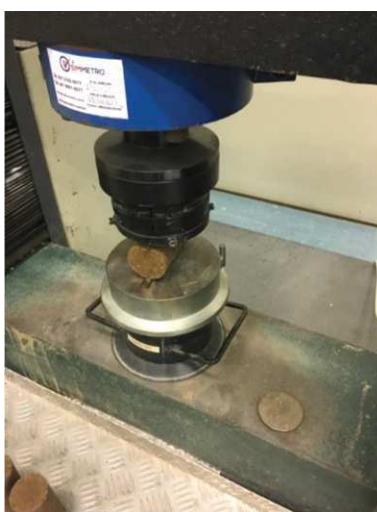
Figura 59: Ensaio de resistência à tração por compressão diametral.
