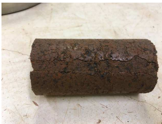
Figura 52: Corpo de prova após ensaio de RTCD.
