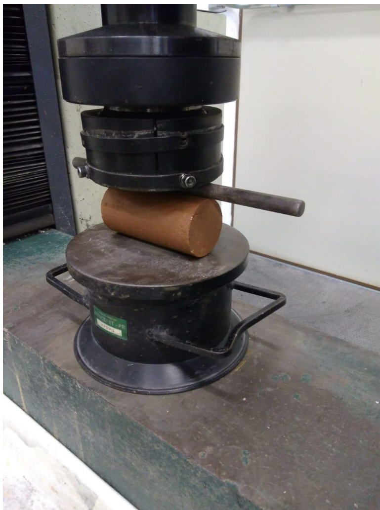
Figura 17 - Ensaio de tração por compressão diametral.
