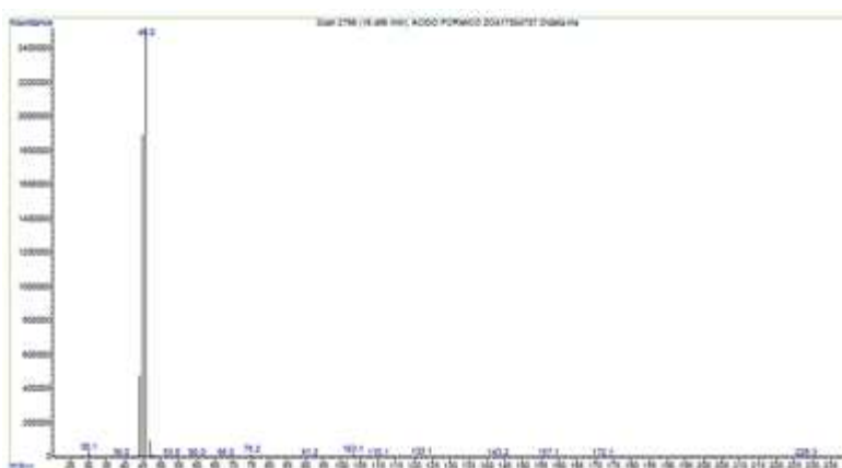
Figura 27 – Espectro do ácido fórmico, obtido experimentalmente pela através da técnica de massas.
