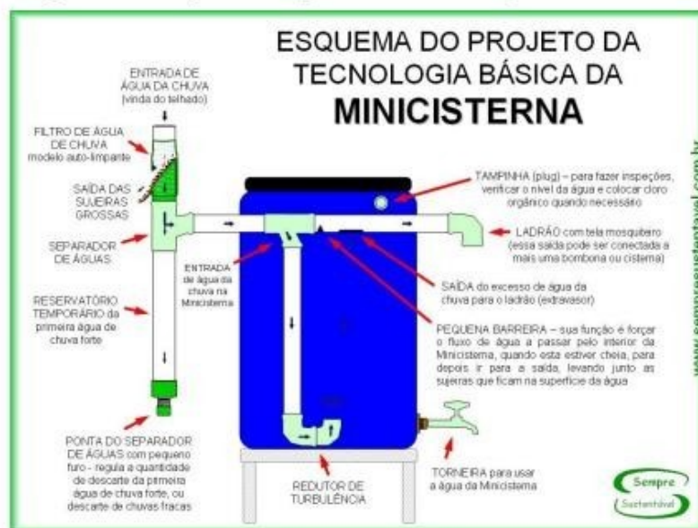
Figura 8 - Esquema de aproveitamento de água da chuva por meio de minicisterna
