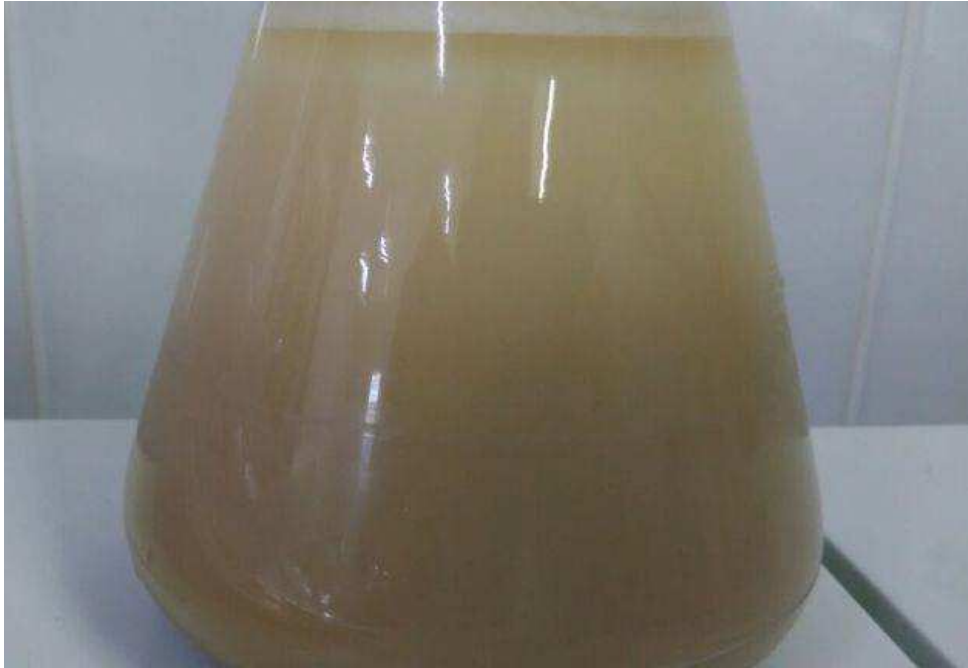
Figura 1: Separação da fase que contém leveduras sadias do trub e leveduras mortas. A parte superior e mais clara contém as leveduras vivas, já na parte escura, estão as leveduras mortas e proteínas.
