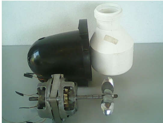
Figura 20 - Carcaça e proteção do gerador.
