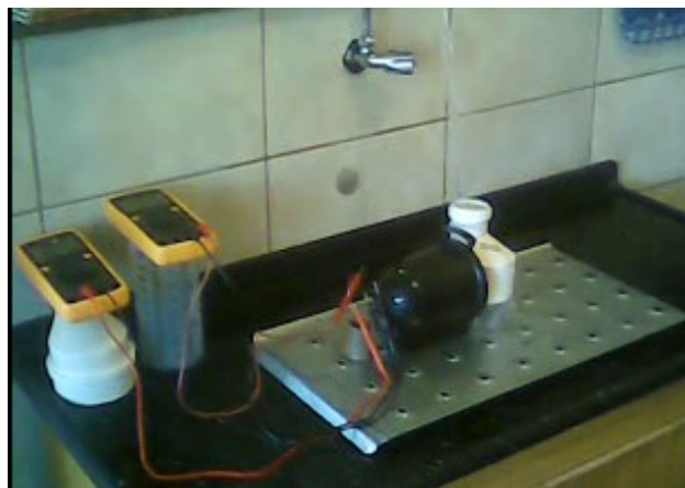
Figura 43 – Ensaio de geração de energia com múltiplas leituras simultâneas.
