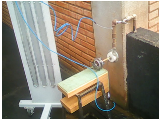
Figura 46 - Esquema do ensaio de perda de carga.
