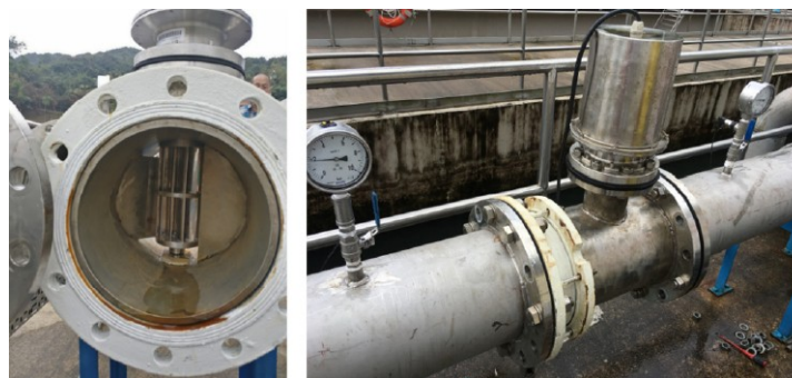
Figura 10 - Turbina de fluxo cruzado e equipamentos para testes.
