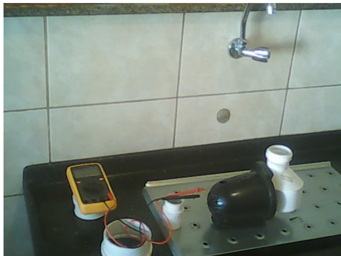
Figura 39 – Ensaio de geração de energia com água do reservatório.
