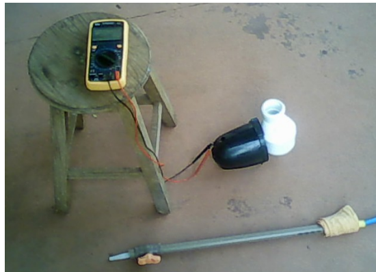
Figura 35 - Ensaio de geração de energia com água direto da rede de abastecimento.
