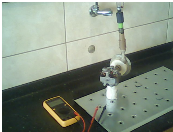
Figura 41 – Ensaio de geração de energia com água do reservatório.
