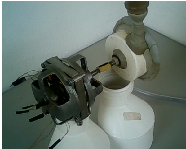
Figura 37 - Ensaio de geração de energia com água direto da rede de abastecimento.
