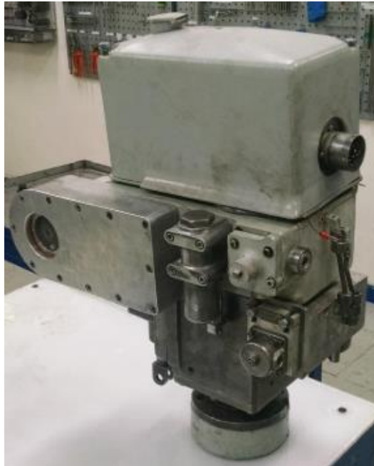
Figura 15 - Exemplar de um governador de locomotiva diesel elétrica.
