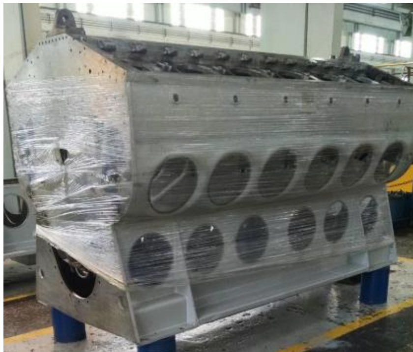
Figura 10 - Bloco do motor diesel.
