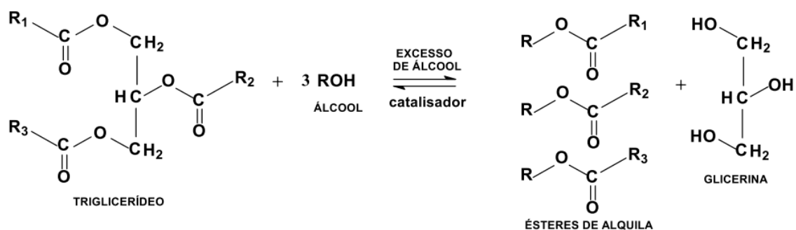
Figura 1 - Transesterifica\u00e7\u00e3o de um triglicer\u00eddeo Fonte: Rodrigues (2007).
