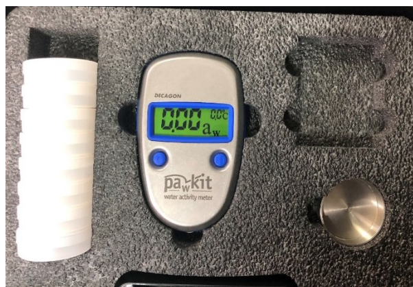
Figura 9. Medidor de atividade da água ( A_w ) da marca Decagon, utilizado nas análises do cosmético.
