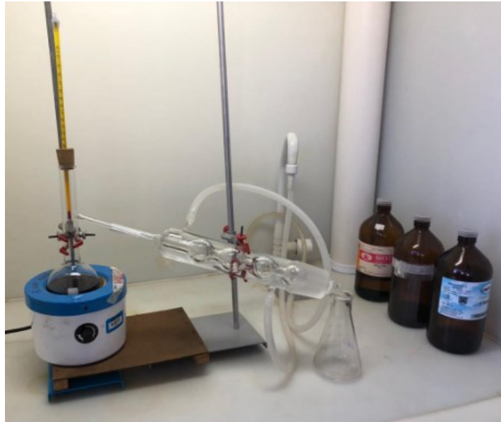
Figura 4. Sistema de destilação fracionada utilizado para obtenção do pigmento.
