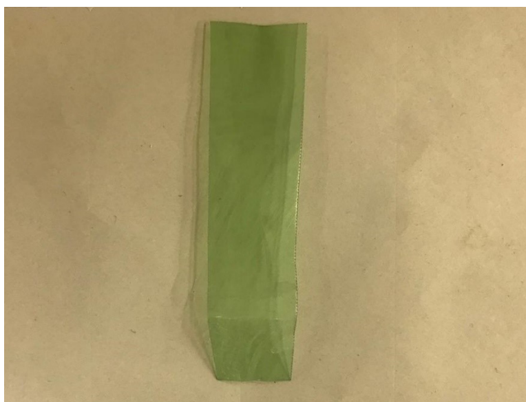
Figura 11 - Amostra de PET após contato com tolueno
