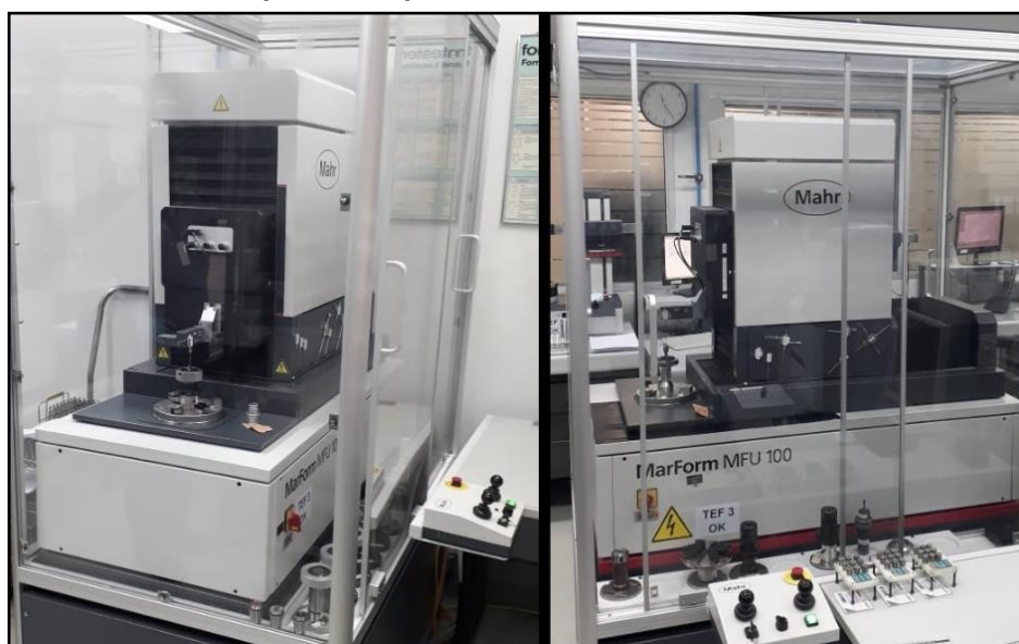
Figura 24 - Equipamento de medição das características avaliadas para Capabilidade de máquina e de processo, “MarForm MFU100”
