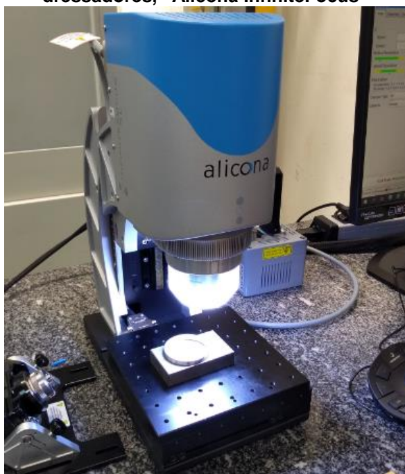
Figura 25 - Equipamento de medição óptica 3D usado para medir os diâmetros dos anéis dressadores, "Alicona InfiniteFocus"
