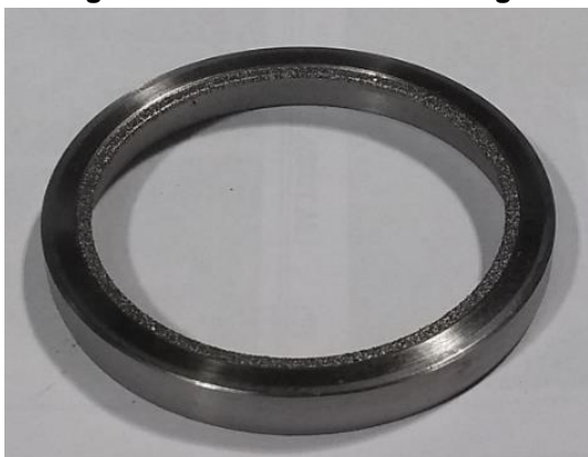
Figura 7 - Dressador galvânico utilizado na dressagem do rebolo de guia
