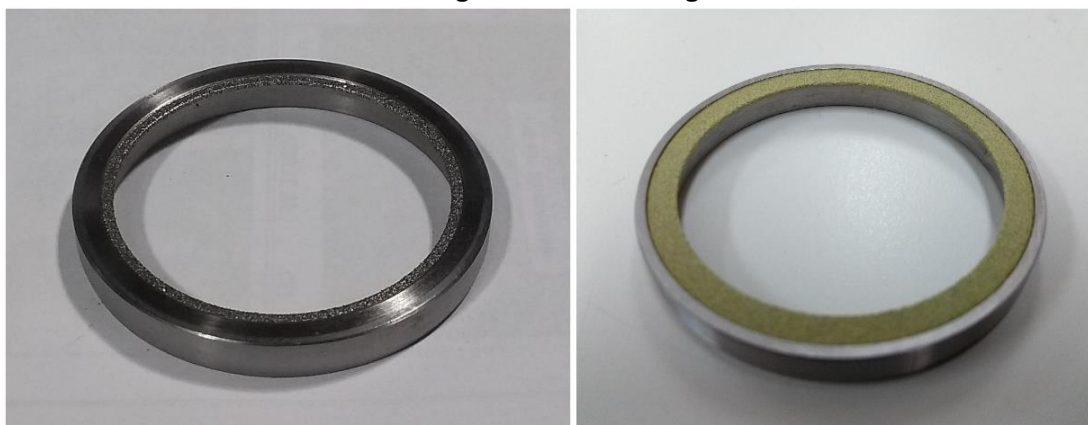
Figura 13 - Dressadores galvânico (à esquerda) e cerâmico (à direita) responsáveis pela dressagem do rebolo de guia
