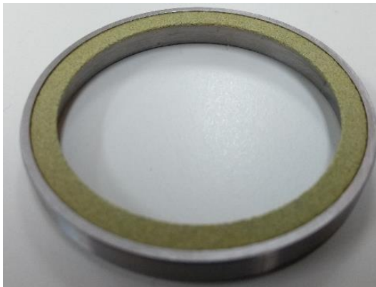
Figura 9 - Dressador cerâmico proposto para a dressagem do rebolo de guia
