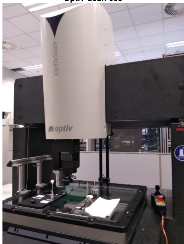
Figura 18 - Equipamento de medição dos diâmetros dos dressadores, " Hexagon Metrology – Optiv Scan 663"
