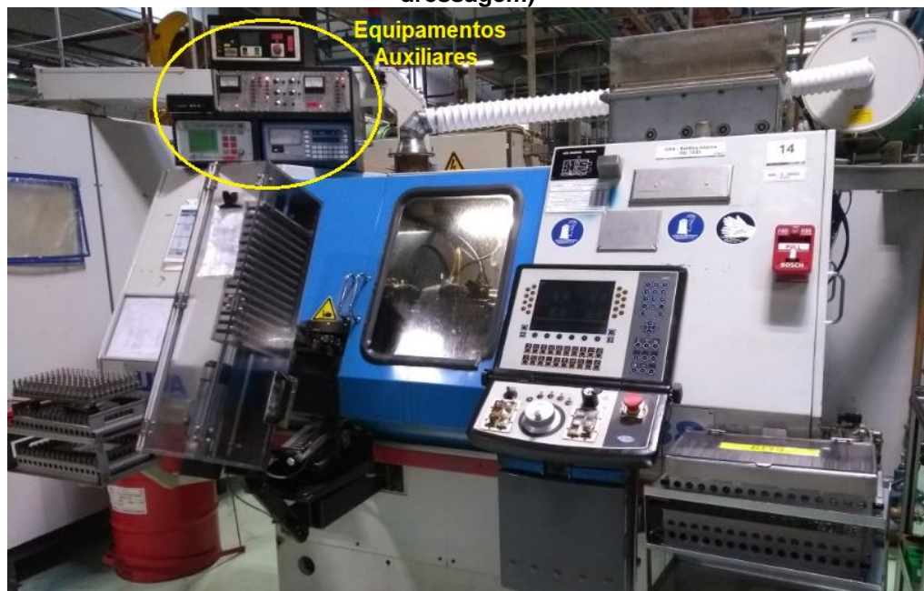
Figura 20 - Máquina retificadora utilizada nos testes (detalhe para equipamentos auxiliares da dressagem)
