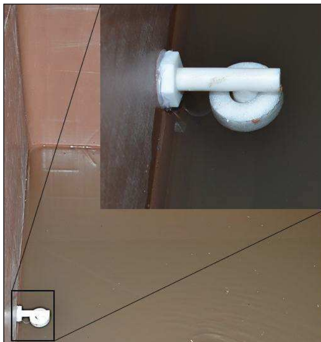
Figura 18: Detalhe da boia para manter o nível do reservatório constante
