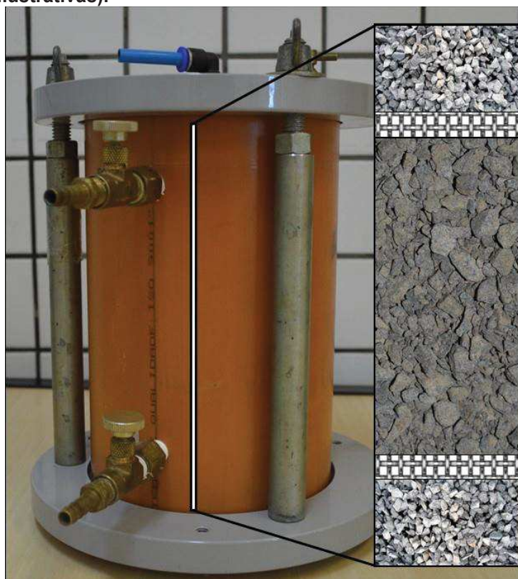
Figura 14: Ilustração das camadas do corpo de prova para o ensaio de permeabilidade (espessuras das camadas são ilustrativas).
