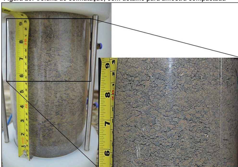
Figura 20: Coluna de colmatação, com detalhe para amostra compactada
