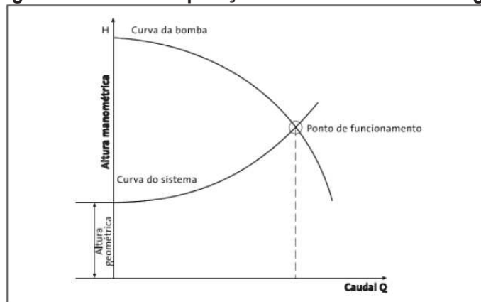
Figura 7 – Ponto de operação de uma bomba centrífuga.
