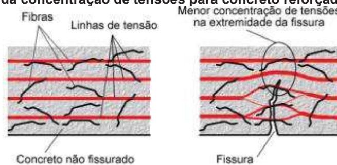
Figura 6 - Esquema da concentração de tensões para concreto reforçado com fibras
