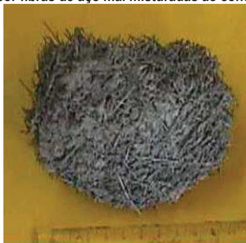
Figura 9 - Ouriço formado por fibras de aço mal misturadas ao concreto
