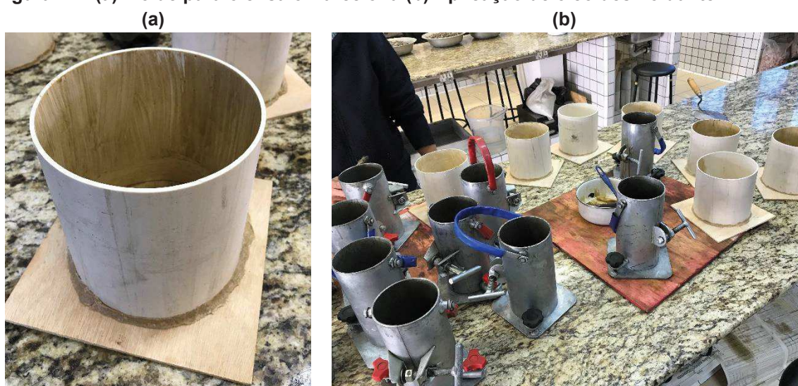
Figura 21 - (a) Molde para o ensaio Barcelona (b) Aplicação de óleo desmoldante
