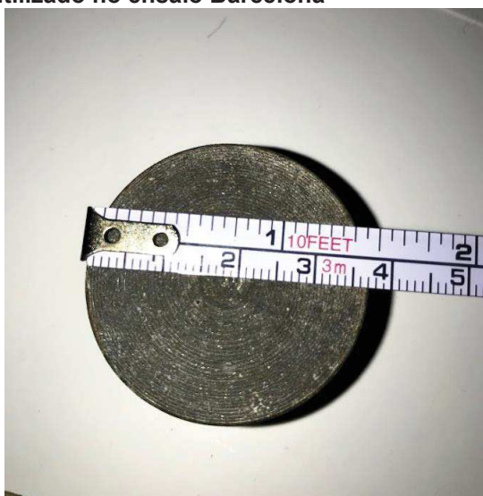
Figura 23 - Disco de aço utilizado no ensaio Barcelona
