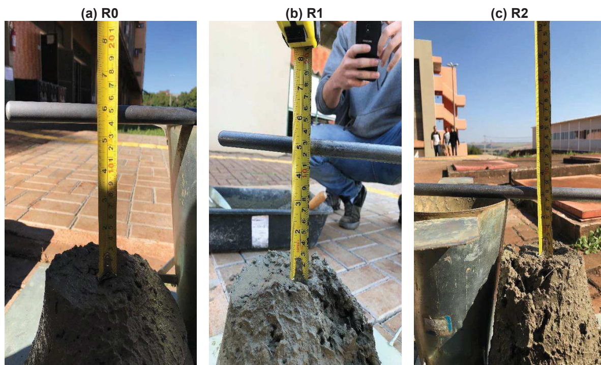
Figura 25 - Resultados do slump test : (a) Sem fibras; (b) 0,5% de fibras; (c) 1,0% de fibras.
