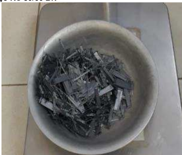
Figura 20 - Fibras de aço RC 80/60 BN
