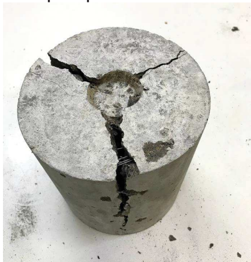
Figura 32 - Modo de ruptura do corpo de prova no ensaio Barcelona
