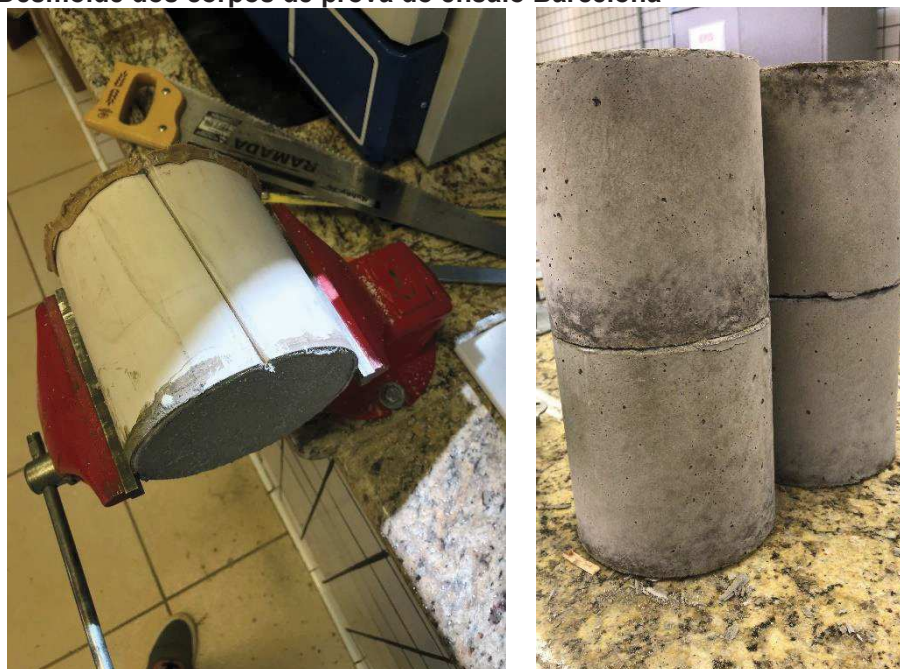
Figura 22 - Desmolde dos corpos de prova do ensaio Barcelona
