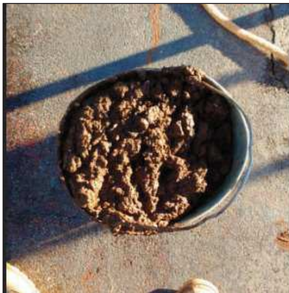
Figura 3 – Lodo retirado do decantador de uma ETA
