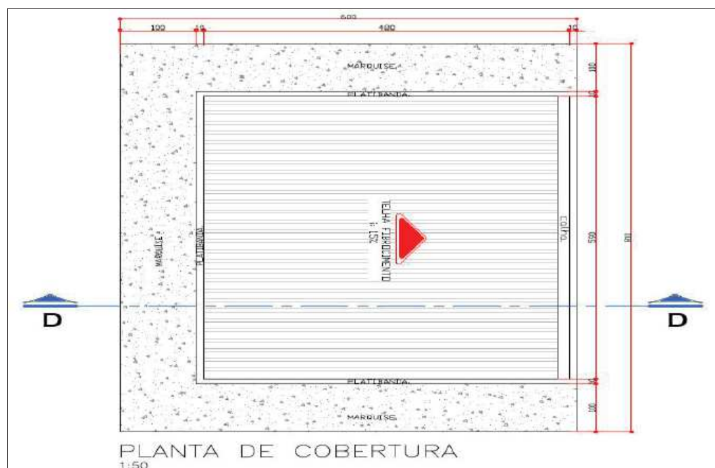
Figura 20 - Planta da Cobertura
