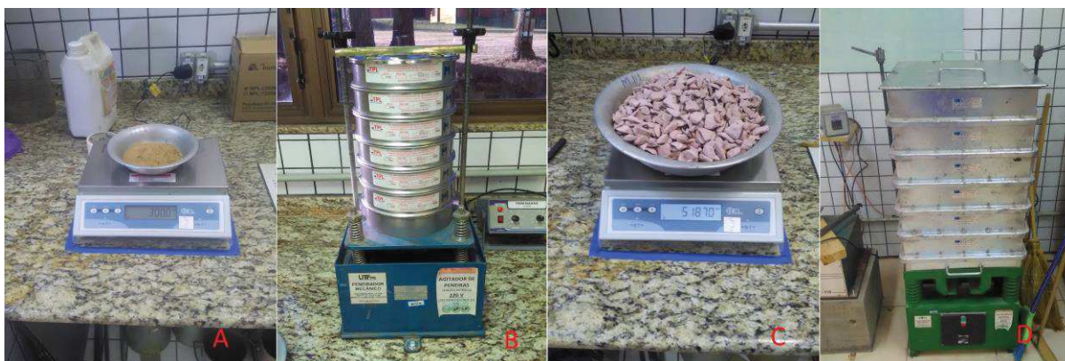
Figura 5 - A: Amostra de agregado miúdo; B: Peneiras para o agregado miúdo; C: Amostra de agregado graúdo e D: Peneiras de agregado graúdo
