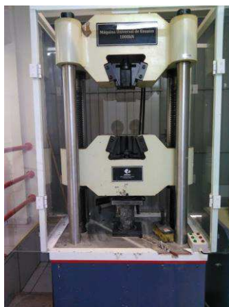
Figura 17 - Máquina utilizada para ensaio de módulo de elasticidade e resistência à compressão dos corpos de prova
