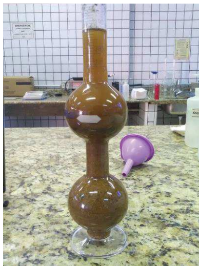
Figura 9 - Ensaio de massa específica realizado
