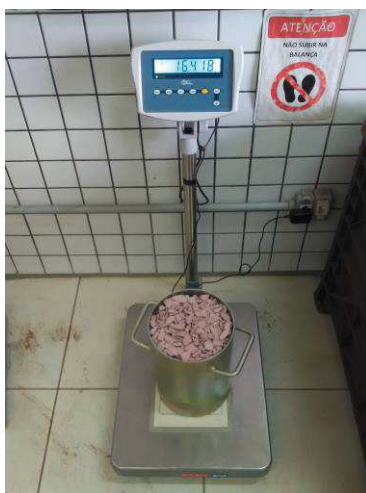
Figura 11 – Verificação da massa do recipiente com agregado graúdo
