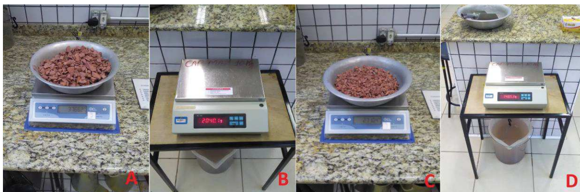
Figura 10 – A e C: Verificação dos valores de massa do agregado saturado com superfície seca; B e D: Verificação dos valores de massa do agregado submersa
