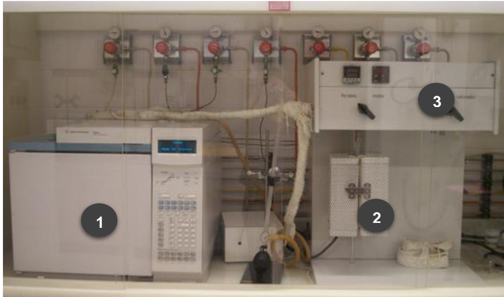
Figura 8. Sistema de avaliação catalítica, onde 1 representa o cromatógrafo, 2 o forno e o reator e 3 a unidade multipropósito.
