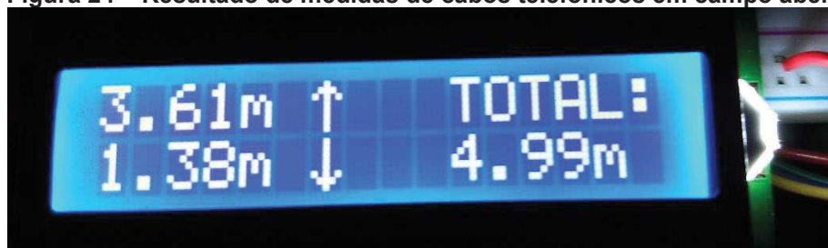
Figura 24 – Resultado de medidas de cabos telefônicos em campo aberto
