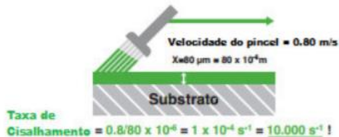
Figura 5: Taxa de deformação na aplicação de tinta por pincel.
