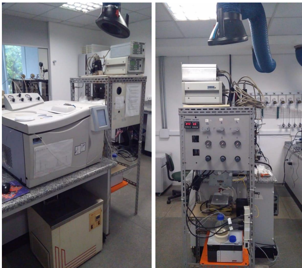
Figura 20 - Unidade de testes catalíticos onde as reações de tri-reforma foram conduzidas.
