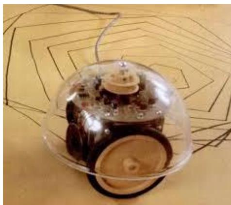
**Figura 2.1-1 Modelo da tartaruga mecânica criada por Seymour Papert**
