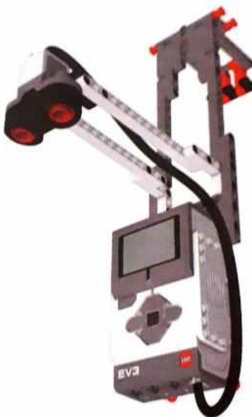
**Figura 4.1.3-1 Robô medidor de altura**
