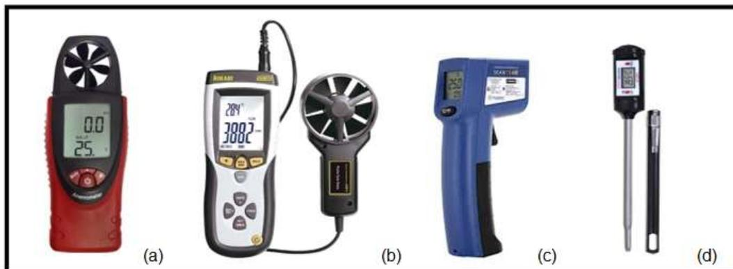
Figura 7 - Termohigrômetro digital (a), anemômetro digital de hélice (b), termômetro digital infravermelho com mira laser (c) e termômetro digital tipo espeto (d)
