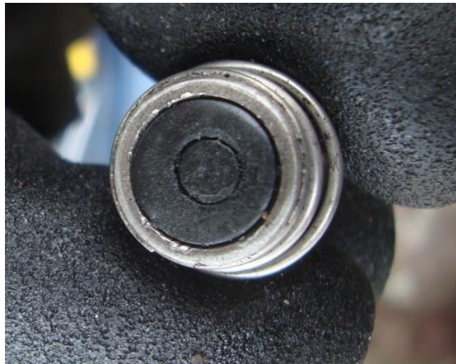
Fotografia 1 - Modelo de vedação utilizada e desgaste
