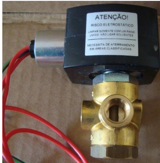
Fotografia 8 - Válvula solenoide utilizada no projeto
