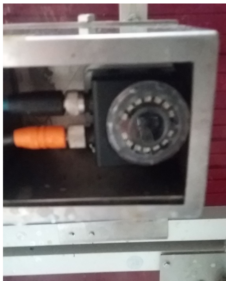
Figura 5 - Sensor dentro da caixa protetora
