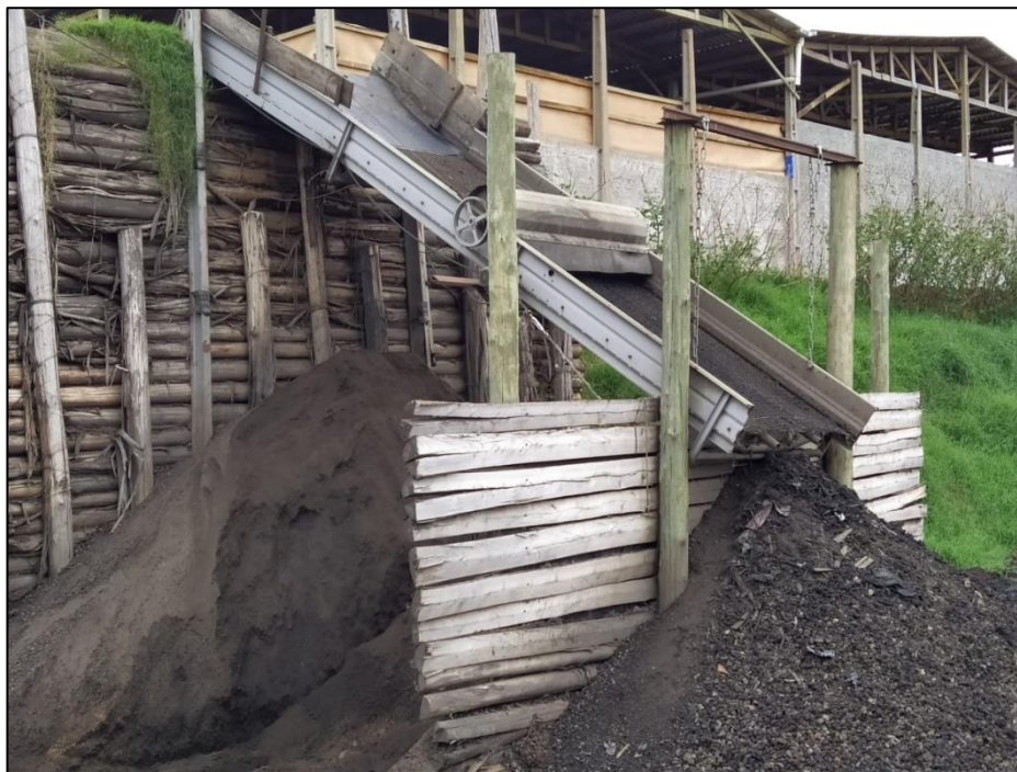
Figura 17 - Equipamento estacionário para peneiramento.
