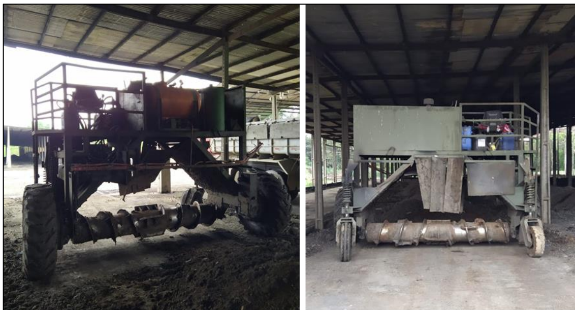
Figura 15 - Equipamento para revolvimento de leiras.
