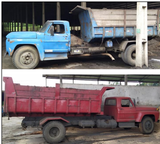
Figura 13 - Equipamentos Móveis no processo de enleiramento e transportes internos. (a) Caminhão vermelho 16m 3 (b) Caminhão Azul 10,5 m 3 .
