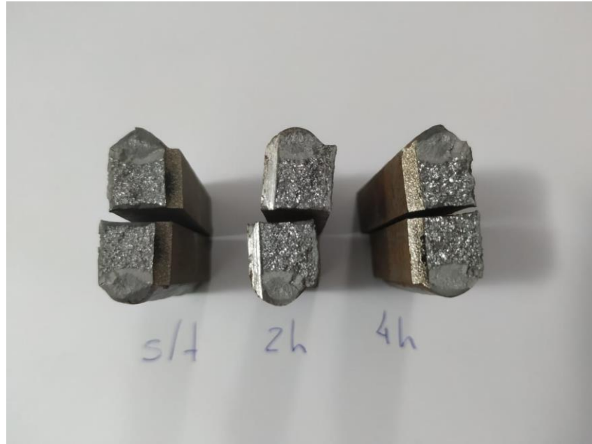
Figure 11 - Aspectos da fratura no material ensaiado
