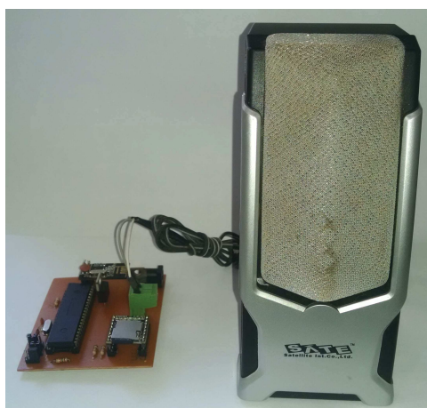
Figura 23: Auto falante 3 W conectado na PCI Ponto. Fonte: Autoria própria.
