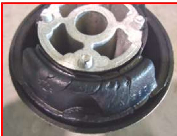
Figura 3 – Peça com falha de preenchimento
