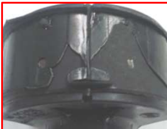
Figura 6 – Peça com falta de material
