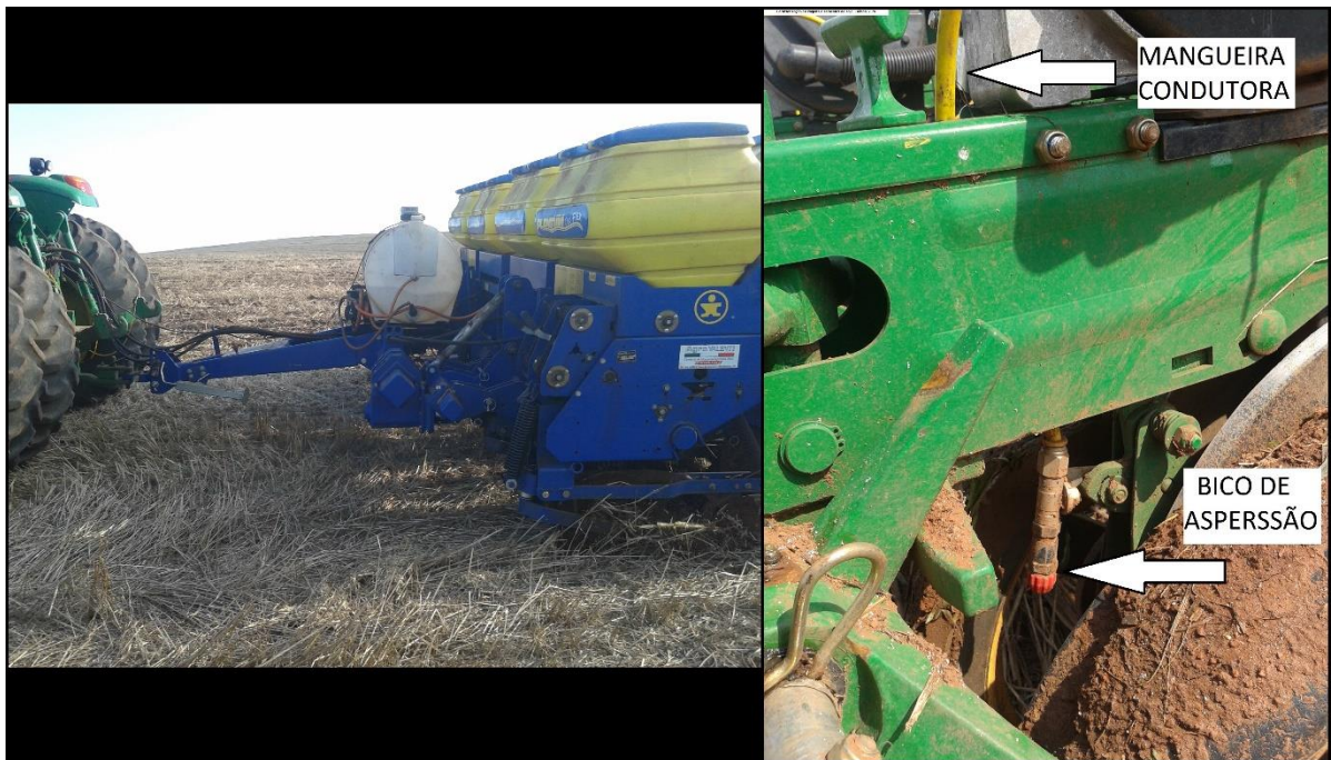
Figura 02: Equipamento de semeadura e sistema de jato dirigido. Fonte: Autor
