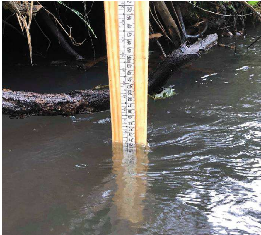
Figura 29 - Medição de profundidade na seção
