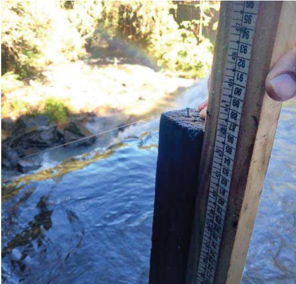
Figura 25 - Medição da altura da estaca.
