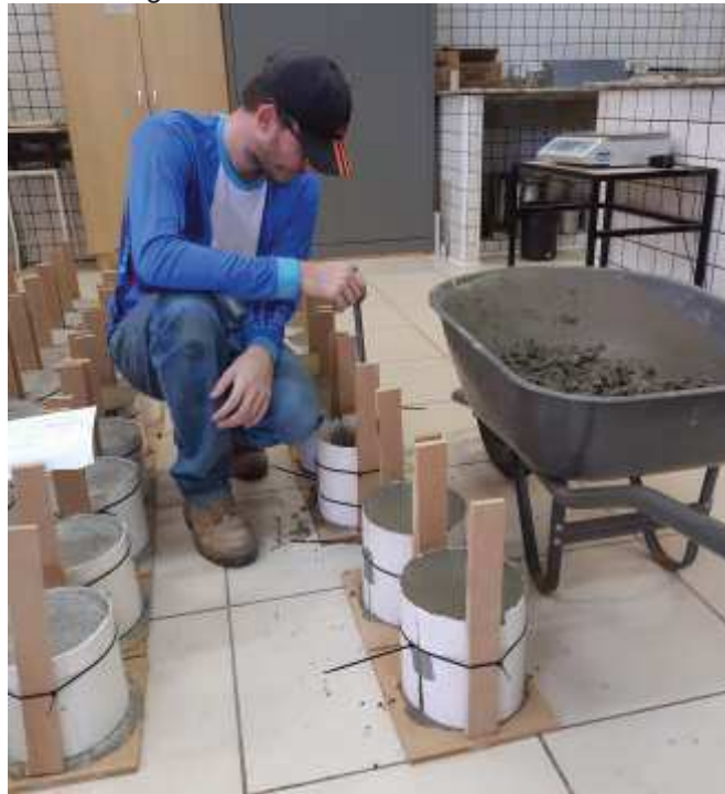
Figura 31 – Adensamento do concreto
