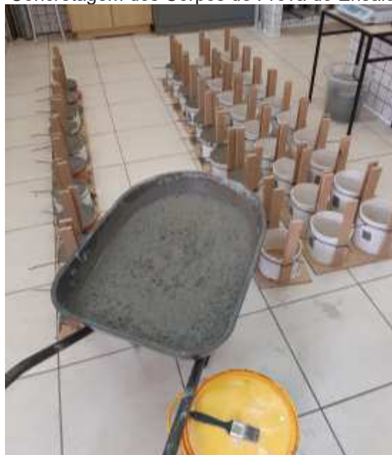
Figura 30 – Concretagem dos Corpos de Prova do Ensaio de Pull-Out
