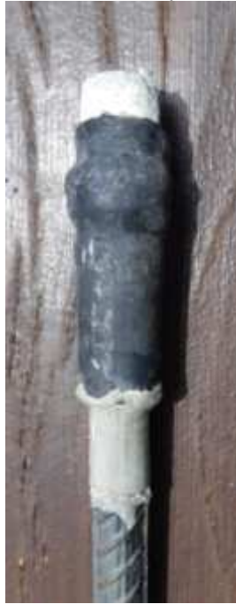
Figura 48 – Formação da cunha causada pelo não deslocamento da bucha
