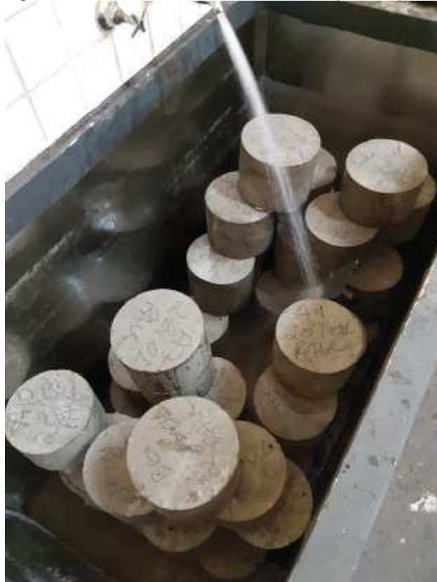
Figura 34 – Início da cura úmida dos corpos de prova
