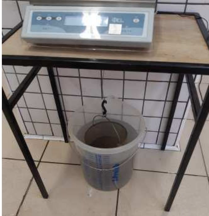
Figura 23 – Agregado Graúdo submerso em água para pesagem
