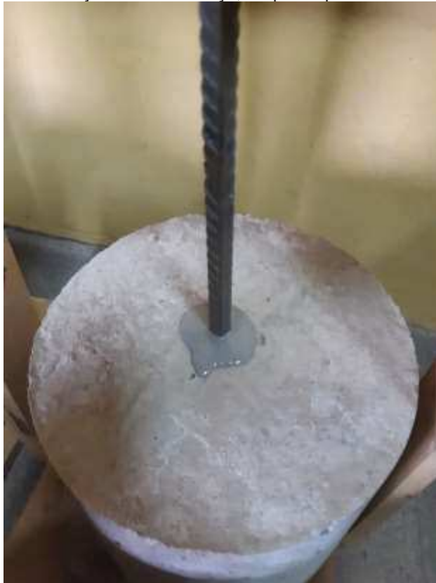
Figura 42 – Conjunto barra de aço, corpo de prova e resina epóxi
