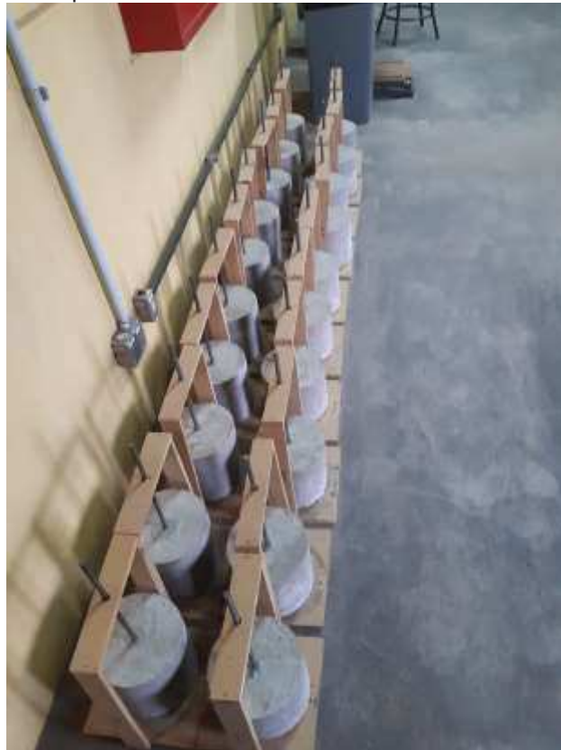
Figura 43 – Corpos de prova em ambiente de laboratório durante a secagem da resina
