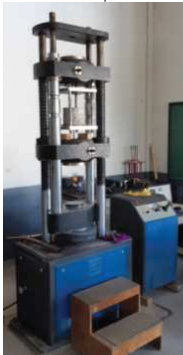
Figura 46 – Prensa hidráulica com adaptador durante o ensaio de Pull-Out
