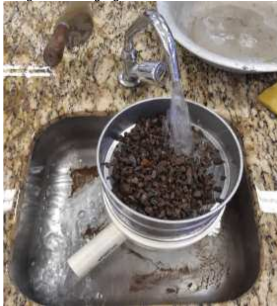
Figura 21 – Agregado Graúdo sendo lavado
