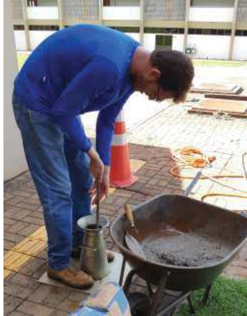
Figura 29 – Realização do ensaio de Slump Test
