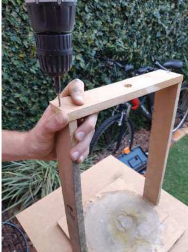
Figura 35 – Construção do suporte para a colagem das barras com resina epóxi
