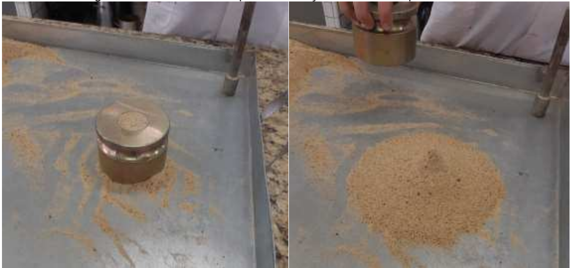
Figura 18 – Procedimento para verificação da umidade para o ensaio
