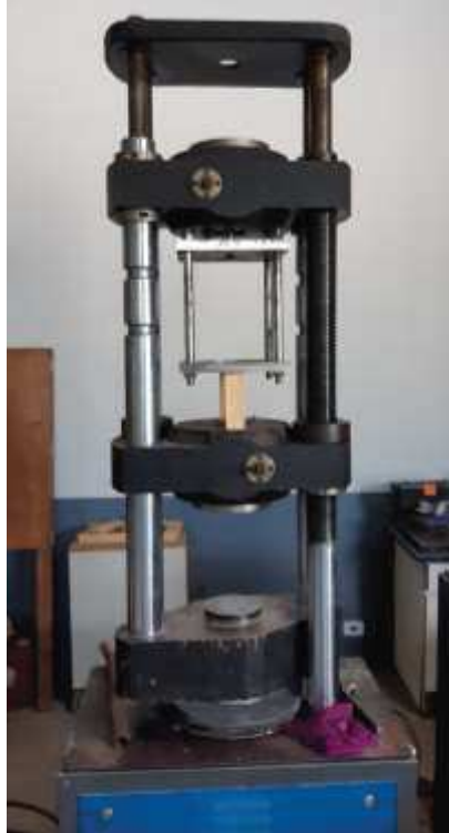
Figura 44 – Adaptador montado na prensa
