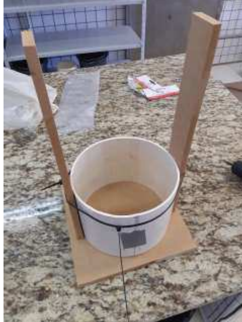
Figura 27 – Molde pronto para a concretagem
