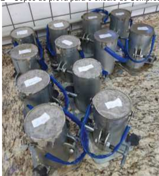
Figura 32 – Copos de prova para o ensaio de Compressão Axial
