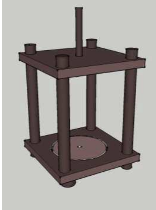
Figura 10 – Modelo 3D do adaptador para o ensaio Pull-Out
