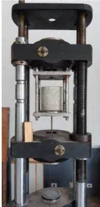
Figura 45 – Adaptador, corpo de prova e prensa durante o ensaio de Pull-Out
