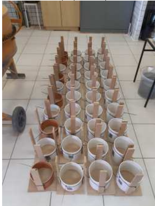
Figura 28 – Moldes preparados para concretagem
