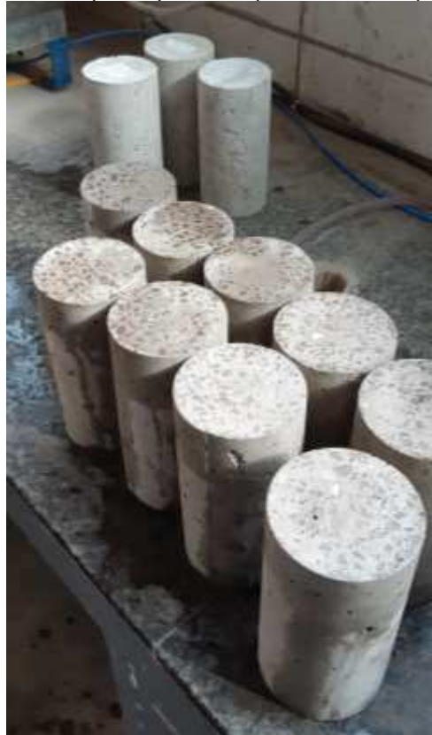
Figura 47 – Corpo de prova no processo de capeamento
