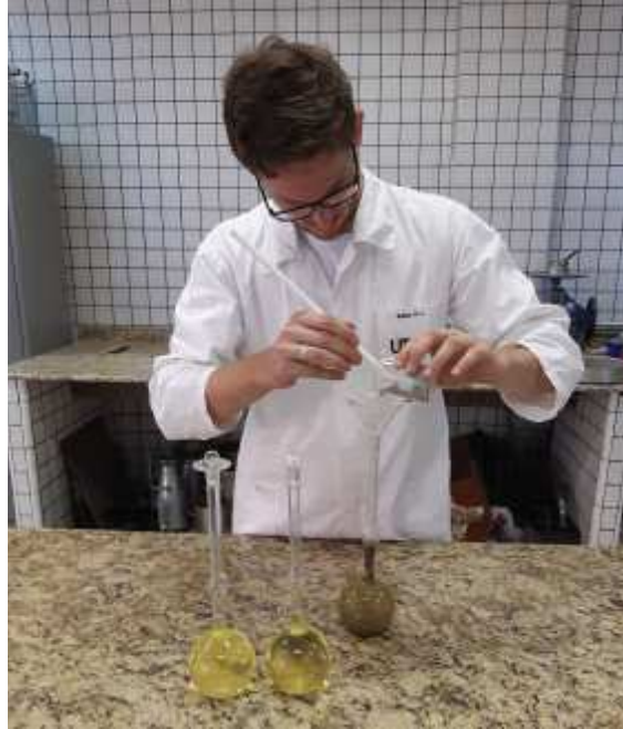
Figura 24 – Cimento sendo introduzido no frasco de Le Chatelier
