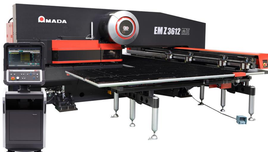
Figura 7 - Representação da puncionadeira utilizada no processo
