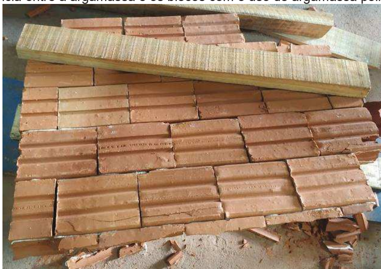
Figura 15 - Aderência entre a argamassa e os blocos com o uso de argamassa polimérica
