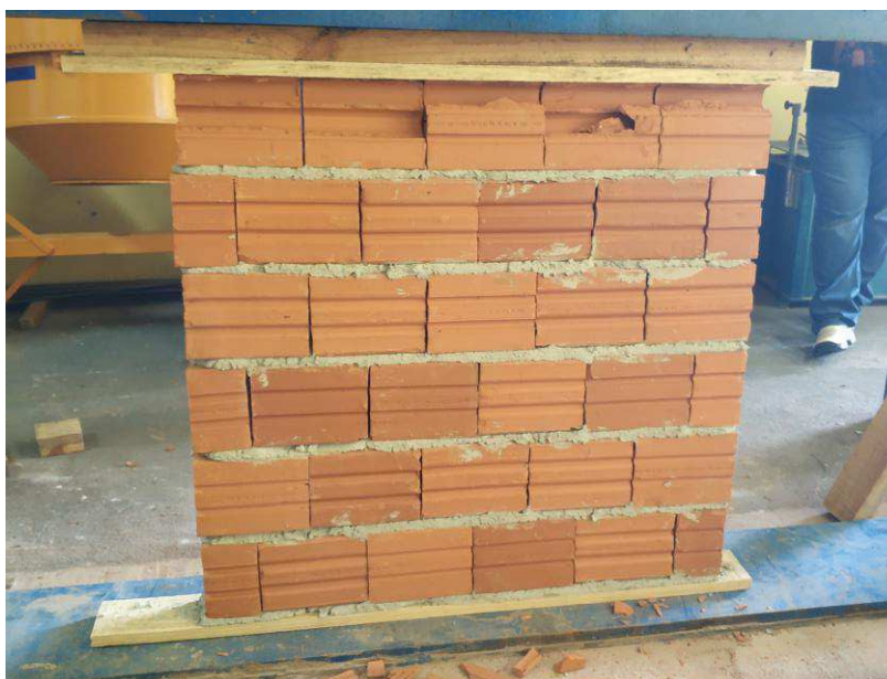
Figura 12 - Fissuração típica protótipo com argamassa convencional apenas na horizontal
