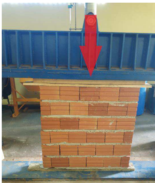
Figura 11 - Sentido de aplicação da força nos corpos de provas.
