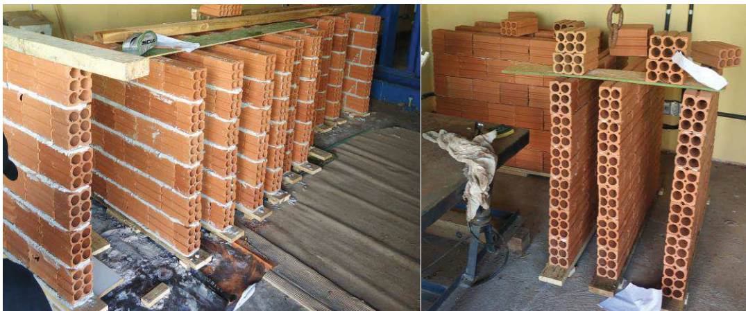
Figura 9 - Corpos de provas utilizados para os ensaios: i - Paredes com argamassa convencional; ii - Parede com argamassa polimérica
