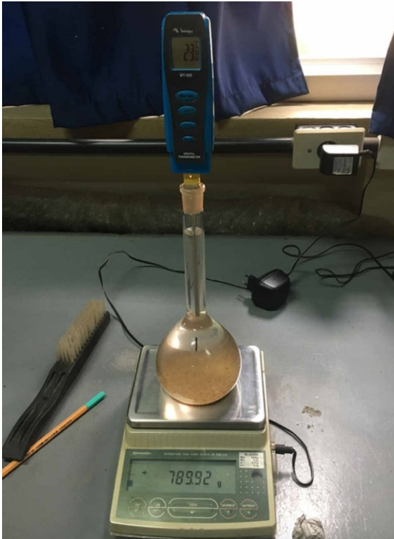
Figura 14 – Determinação da temperatura do conjunto água mais material granular no ensaio 2.
