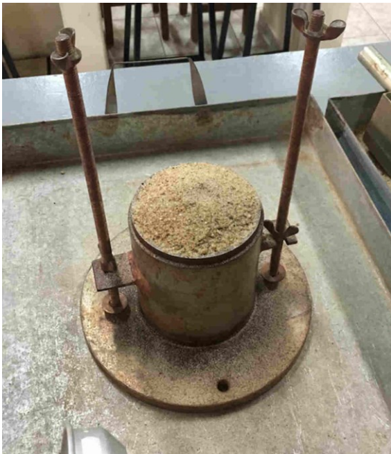
Figura 16 – Molde preenchido com o material granular.
