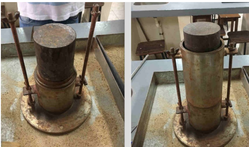
Figura 18 – Molde com sobrecargas.
