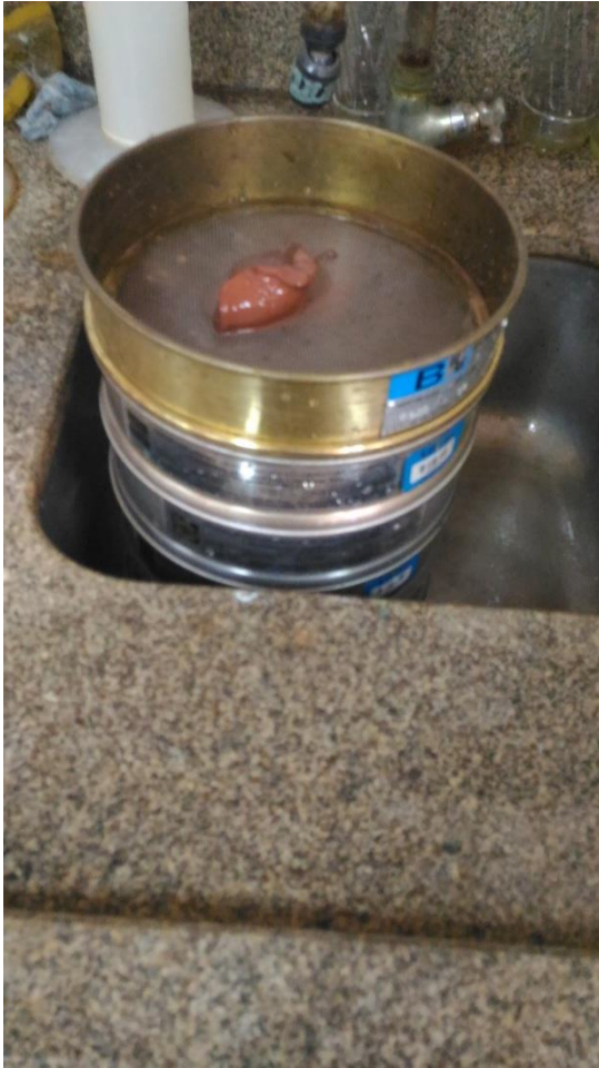
Figura 8 – Conjunto de Peneiras com Amostra de Solo
