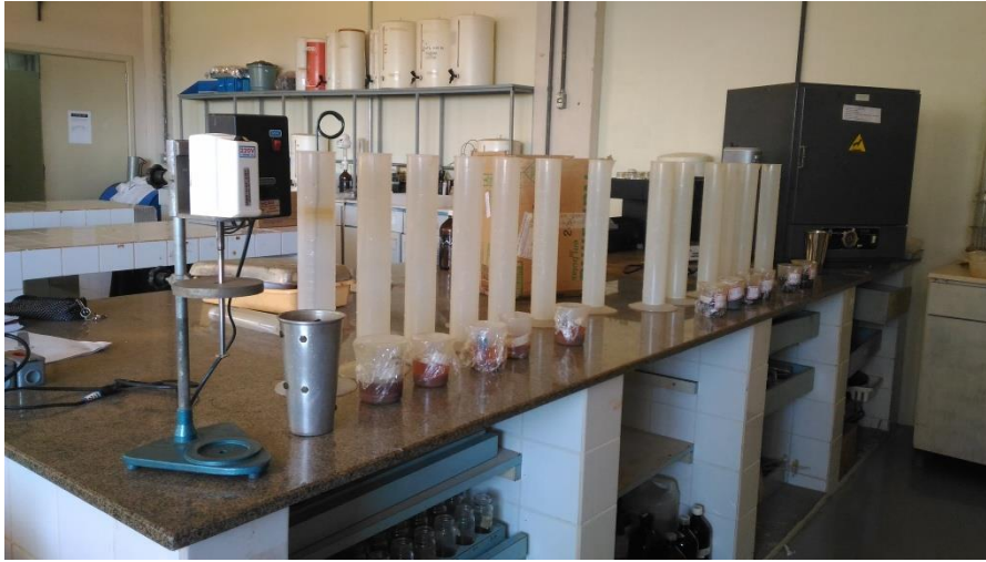
Figura 10 - Ensaio de Determinação da Massa Específica do Solo
