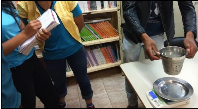
Figura 16 – Estudantes medindo a massa do prato com água condensada após 120 minutos
