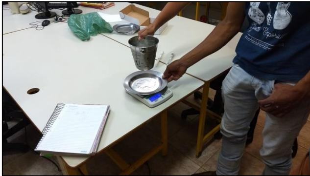
Figura 12 – Estudantes medindo a massa do prato com água condensada após 60 minutos
