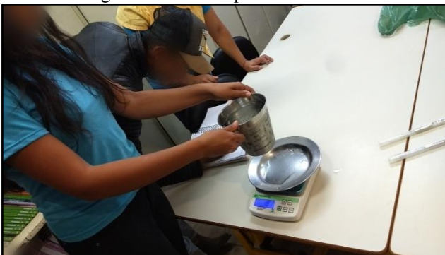
Figura 20 – Estudantes medindo a massa do prato com água condensada após 180 minutos
