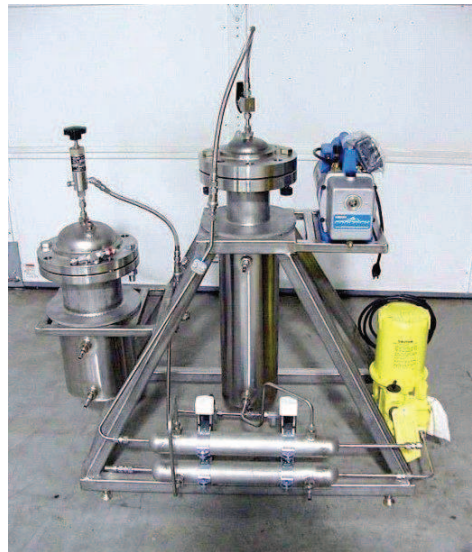
Figura 6 – Processo de extração de óleo essencial por dióxido de carbono supercrítico.
