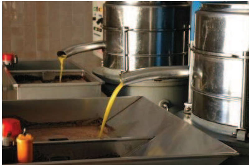
Figura 5 – Processo de prensagem para extração de óleos essenciais de frutas críticas.
