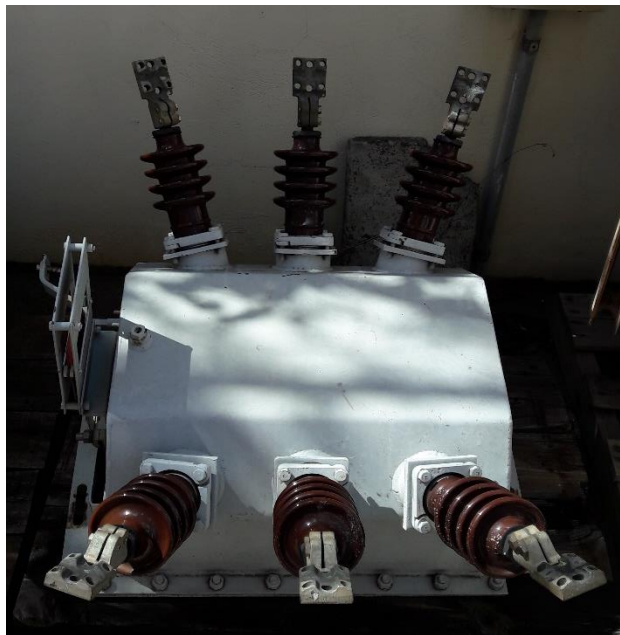
Figura 4 – Chave a óleo tripolar Fonte: Autoria própria
