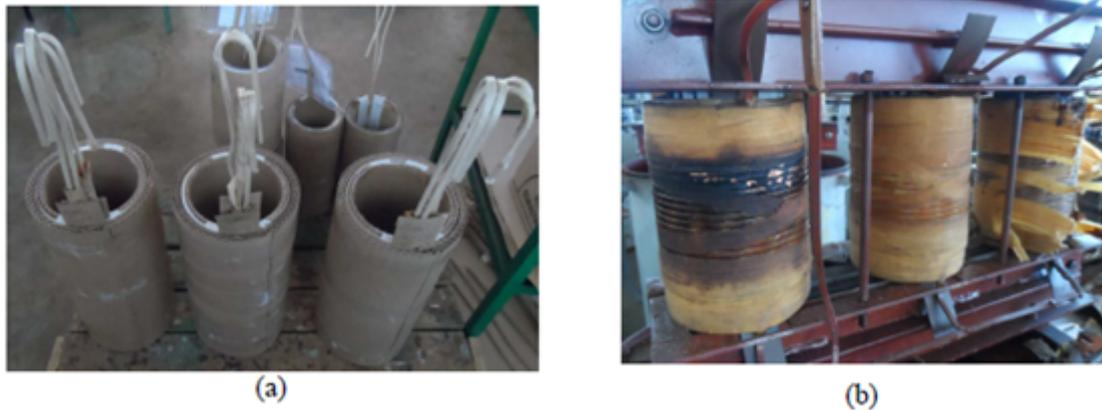
Figura 6 – (a) bobinas recém fabricadas (b) transformador inutilizado devido a falha no papel isolante.
