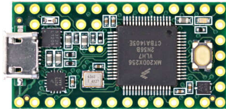
Figura 13. Layout frontal da Teensy 3.2
