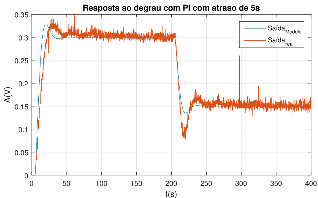
Figura 18 – Comparação dos sinais de saída do sistema simulado e real com controlador PI com atraso de transporte de 5s, aumentando o ganho proporcional do controlador.
